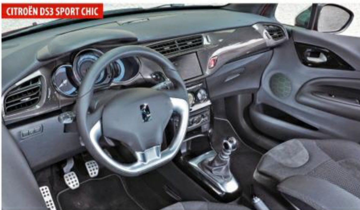
Proche de celle de la Citroën C3, la planche de bord de la DS3 accuse le poids des ans, notamment avec le GPS optionnel et au design daté.
